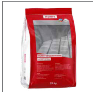
NORIT-Vergussmasse 25 kg/Sack; zementgebundener und polymermodifizierter Fließspachtel, 3 mm Schichtstärke. Verbrauch: ca. 6 / 11 kg/m 2 (E / U)
