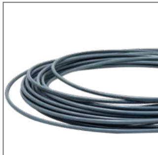
NORIT-Heizrohr 12/16 mm PE-RT (Polyethylen), 12 x 1,3 mm bzw. 16 x 2,0 mm (12 bzw. 16 mm Außendurchmesser, 1,3 bzw. 2,0 mm Wandstärke).
